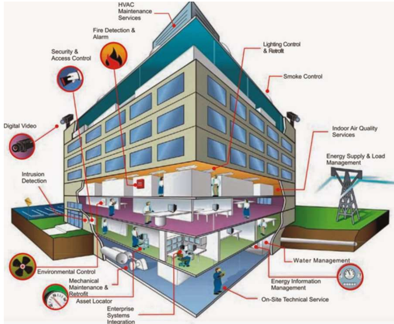
Hệ thống quản lý tòa nhà BMS
